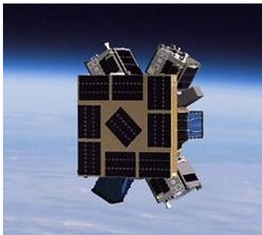
Рис. 2.43. Конструктивная схема ИСЗ LYNK-06 SHANNON (на ступени разведения SHERPA-FX-2 до отделения от нее)
