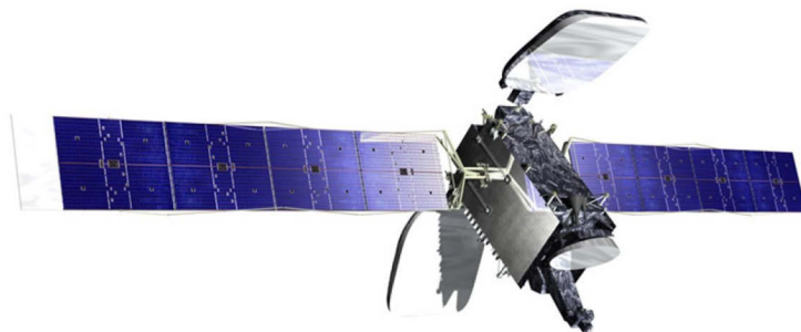
Рис. 4.12. ИСЗ на основе платформы GEOSTAR-2
