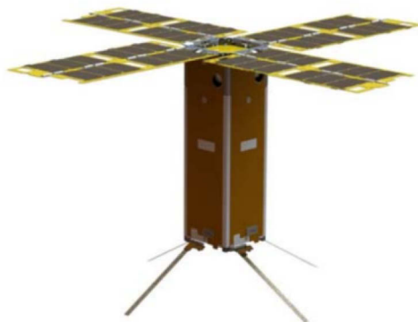
Рис. 4.41. Вариант конструктивного исполнения платформы MISC
