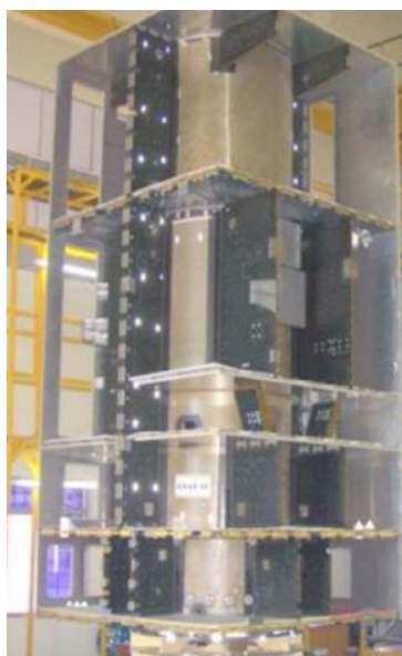
Рис. 4.25. Платформа I-6000 в процессе сборки
