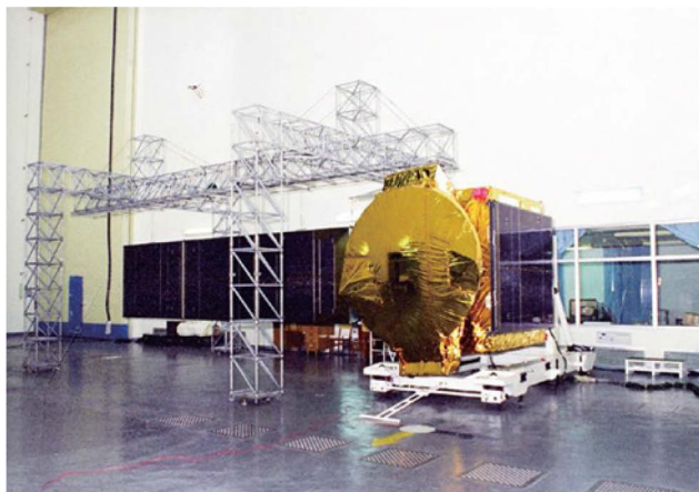
Рис. 4.26. ИСЗ на основе платформы DFH-3
