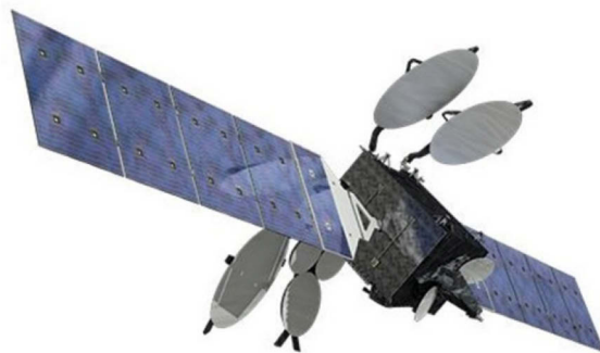
Рис. 4.13. ИСЗ на основе платформы GEOSTAR-3
