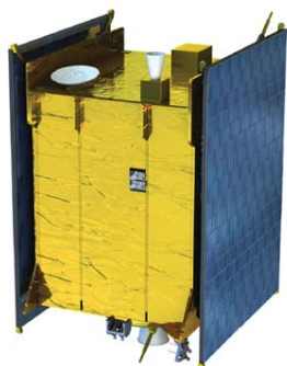
Рис. 4.18. Платформа KSP-2501 со сложенными солнечными батареями
