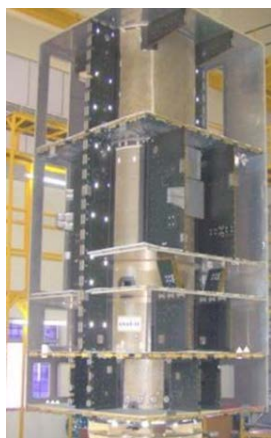
Рис. 4.25. Платформа I-6000 в процессе сборки
