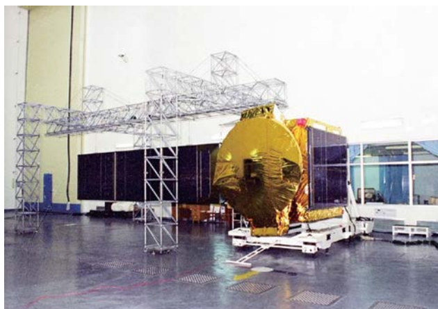
Рис. 4.26. ИСЗ на основе платформы DFH-3
