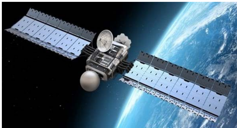
Рис. 4.24. ИСЗ на основе платформы I-4000
