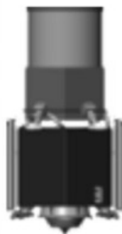
Рис. 4.3. Геостационарный ИСЗ на основе платформы BSS GEM (со сложенными и развернутыми солнечными батареями и антеннами)
