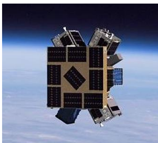
Рис. 2.51. Конструктивная схема ИСЗ LYNK-06 SHANNON (на ступени разведения SHERPA-FX-2 до отделения от нее)
