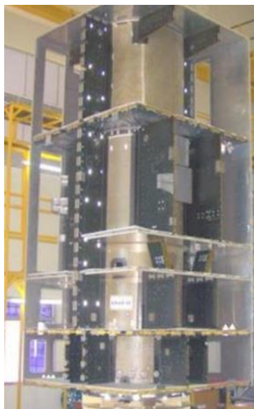
Рис. 4.25. Платформа I-6000 в процессе сборки
