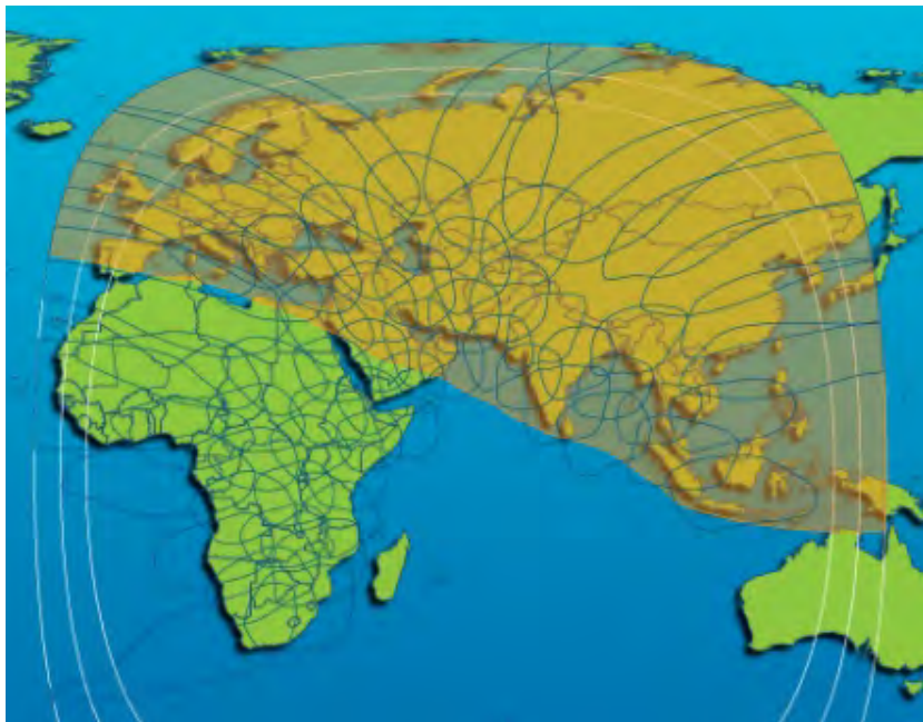
Рис. 122. ЭИИМ (дБ·Вт) в рабочих зонах (многолучевая) ИСЗ INTELSAT-33e (60° в.д.) в Ku-диапазоне частот
