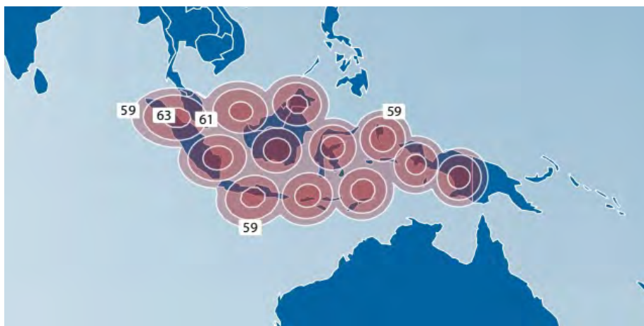
Рис. 61. ЭИИМ (дБ·Вт) в рабочих зонах (12 узких лучей) ИСЗ TELSTAR-18 VANTAGE/APSTAR-5C (138° з.д.) в Ки-диапазоне частот
