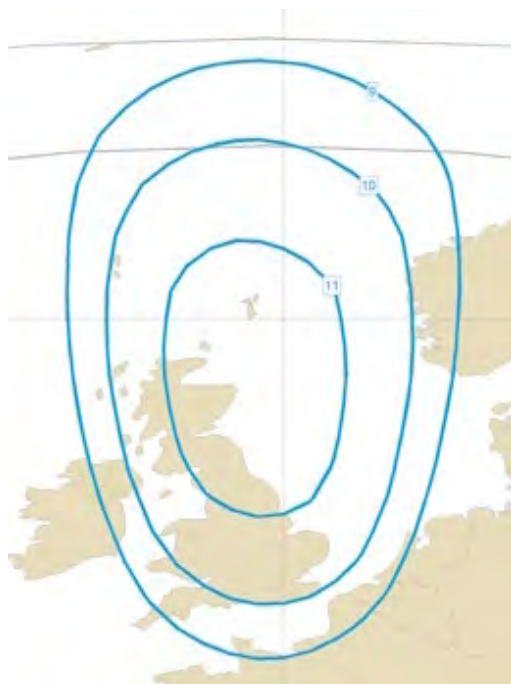
Рис. 10. ЭИИМ (дБ·Вт) в рабочих зонах (вариант перенацеливаемого луча) ИСЗ THOR-7 (1° з.д.) в Ка-диапазоне частот
