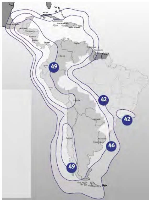
Рис. 10. ЭИИМ (дБ·Вт) в рабочих зонах (Латинская Америка) ИСЗ HISPASAT-74W-1 (STAR ONE-C4) (70° з.д.) в Ku-диапазоне частот
