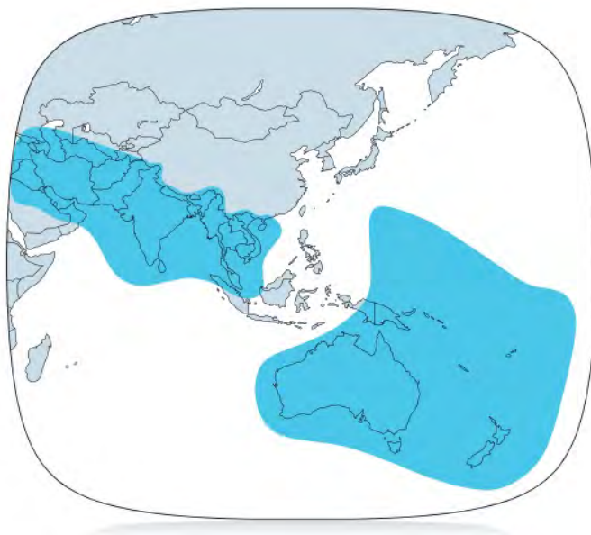
Рис. 38. Рабочие зоны ИСЗ THAICOM-7 (120° в.д.) в С-диапазоне частот
