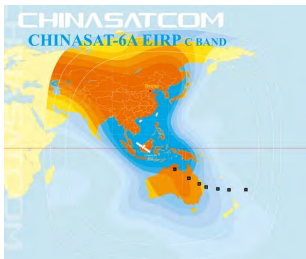
Рис. 8. ЭИИМ (дБ·Вт) в рабочих зонах ИСЗ CHINASAT-6A (125° в.д.) в C-диапазоне частот
