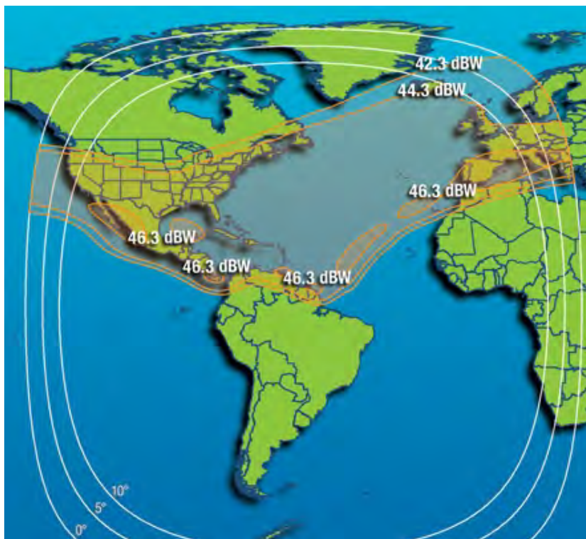
Рис. 115. ЭИИМ (дБ·Вт) в рабочих зонах ИСЗ INTELSAT-34 (55,5° з.д.) в С- (а) и Ku- (б и в) диапазонах частот
