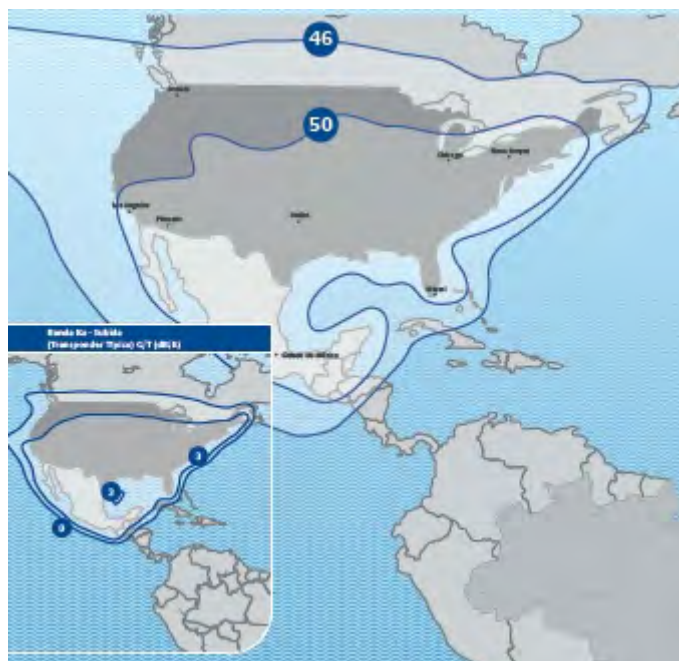
Рис. 11. ЭИИМ (дБ·Вт) в рабочих зонах (Северная Америка) ИСЗ HISPASAT-74W-1 (STAR ONE-C4) (70° з.д.) в Ku-диапазоне частот
