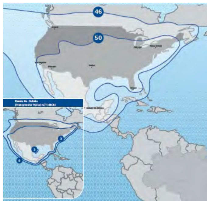
Рис. 22. ЭИИМ (дБ·Вт) в рабочих зонах (Северная Америка) ИСЗ STAR ONE-C4 (70° з.д.) в Ки-диапазоне частот
