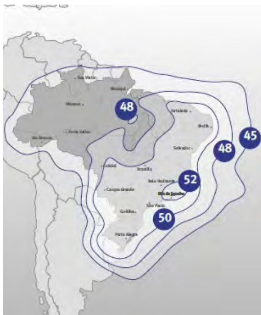
Рис. 9. ЭИИМ (дБ·Вт) в рабочих зонах (Бразилия) ИСЗ HISPASAT-74W-1 (STAR ONE-C4) (70° з.д.) в Ku-диапазоне частот
