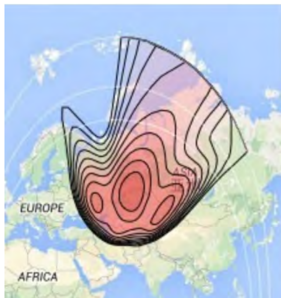
Рис. 4. Рабочая зона (зональный луч) ИСЗ KAZSAT-3 (58,5° в.д.) в Ku-диапазоне частот
