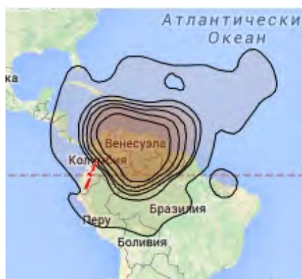
Рис. 6. Рабочие зоны (Венесуэла) ИСЗ VENESAT-1 (78° з.д.) в Ka-диапазоне частот
