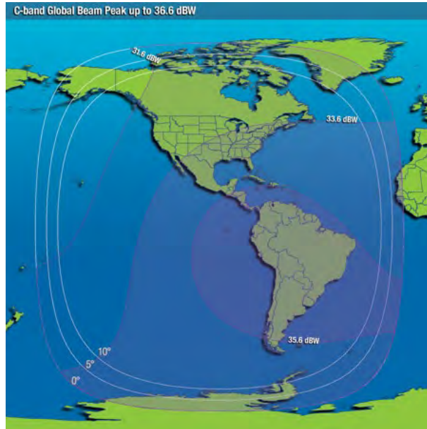
Рис. 119. ЭИИМ (дБ·Вт) в рабочих зонах (полуглобальный луч) ИСЗ INTELSAT-31 (95° з.д.) в С-диапазоне частот
