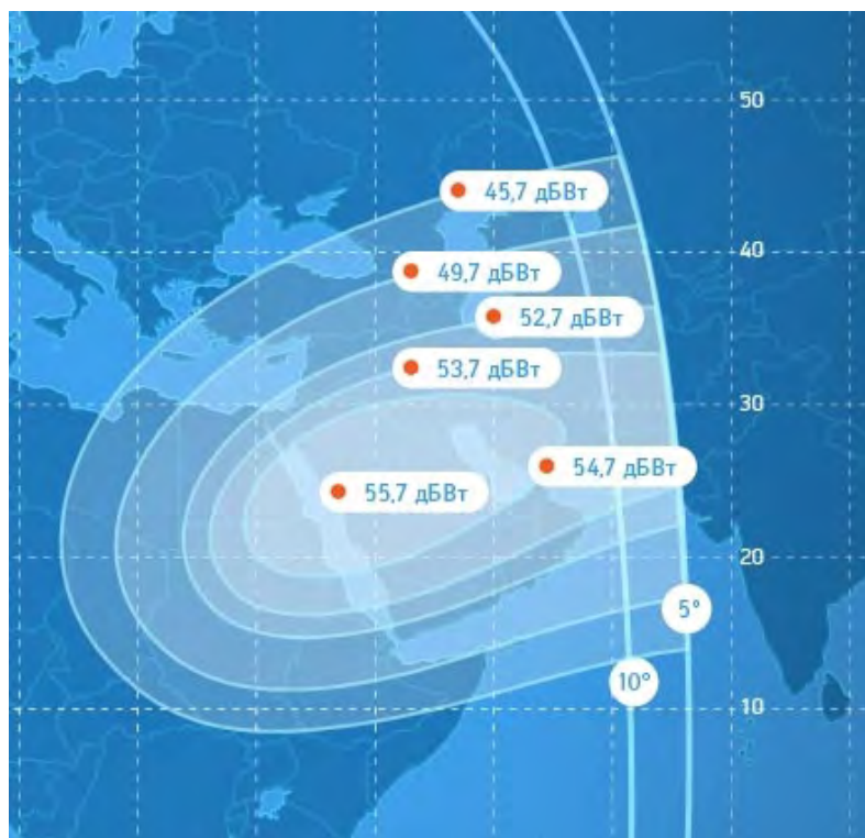
Рис. 14. ЭИИМ (дБ·Вт) в рабочей зоне (2-й вариант перенацеливаемого луча) ИСЗ ЭКСПРЕСС-АМ44 (11° з.д.) в Ки-диапазоне частот
