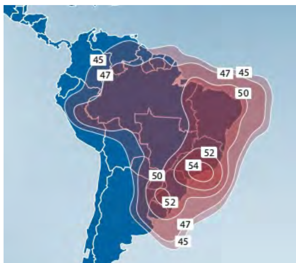
Рис. 56. ЭИИМ (дБ·Вт) в рабочих зонах (два зональных луча) ИСЗ TELSTAR-19 VANTAGE (63° з.д.) в Ки-диапазоне частот
