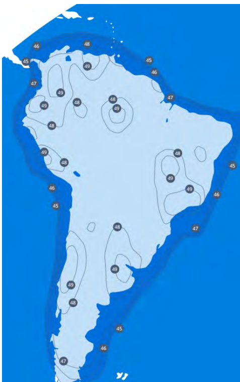
Рис. 7. ЭИИМ (дБ-Вт) в рабочих зонах (на Южную Америку) ИСЗ HISPASAT-74W-1 (AMAZONAS-4 (-4A)) (74° з.д.) в Ки-диапазоне частот
