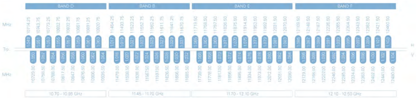
Рис. 48. Частотный план ретрансляторов ИСЗ АСТРА-1М в Ки-диапазоне частот
