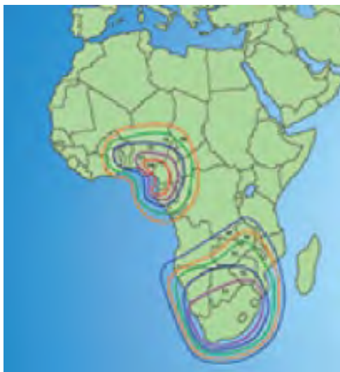
Рис. 19. Планируемая ЭИИМ (дБ·Вт) в рабочих зонах ИСЗ AFRICASAT-2A (5,7° в.д.) в Кu-диапазоне частот
