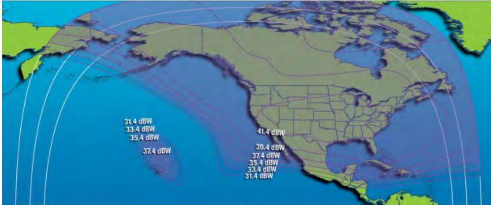
Рис. 71. ЭИИМ (дБ·Вт) в рабочих зонах (горизонтальная поляризация) ИСЗ GALAXY-14 (125° з.д.) в С-диапазоне частот
