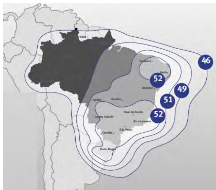
Рис. 24. ЭИИМ (дБ·Вт) в рабочих зонах (Бразилия) ИСЗ STAR ONE-D1 (84° з.д.) в С- (а) и Ку- (б) диапазонах частот
