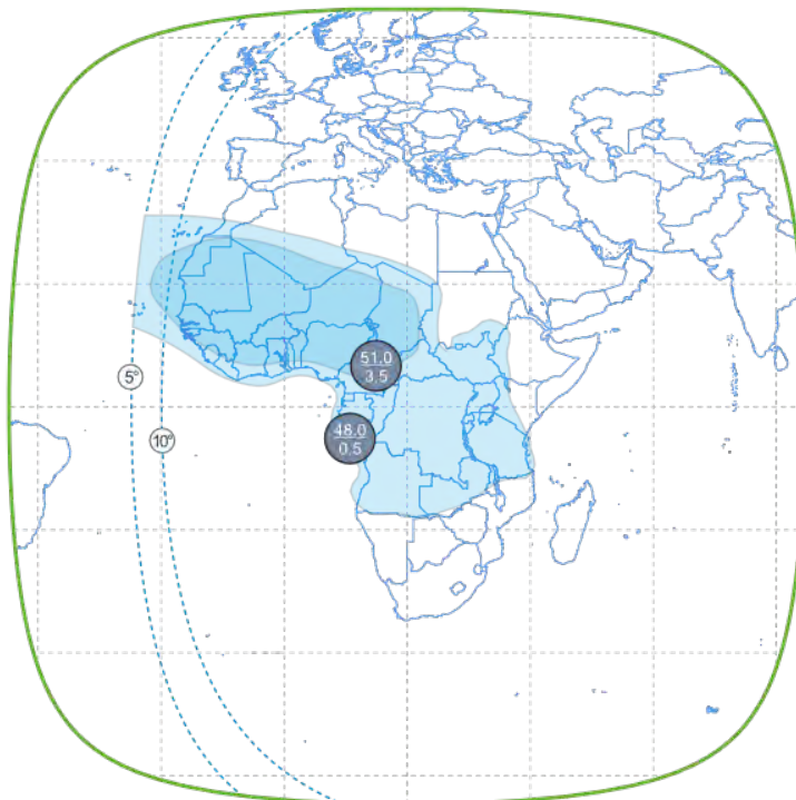
Рис. 5. ЭИИМ (дБ·Вт) в рабочих зонах (африканский луч) ИСЗ BELINTERSAT-1 (51,5° в.д.) в Ки-диапазоне частот
