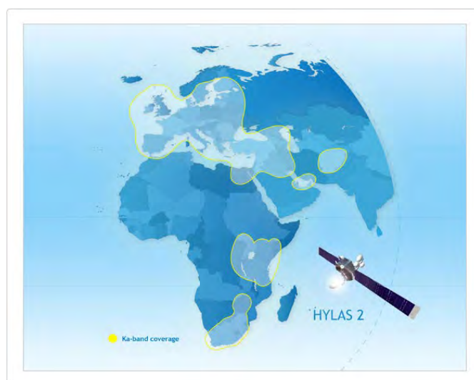
Рис. 35. Рабочие зоны ИСЗ HYLAS-2 (31° в.д.) в Ka-диапазоне частот
