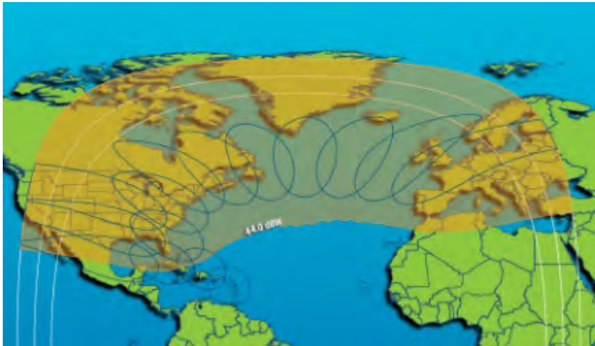
Рис. 67. ЭИИМ (дБ·Вт) в рабочих зонах (многолучевая) ИСЗ SKY-BRASIL-1 (INTELSAT-32e, 43,1° з.д.) в Ku-диапазоне частот
