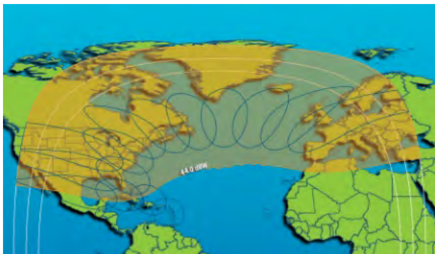
Рис. 124. ЭИИМ (дБ·Вт) в рабочих зонах (многолучевая) ИСЗ INTELSAT-32e (43,1° з.д.) в Ки-диапазоне частот
