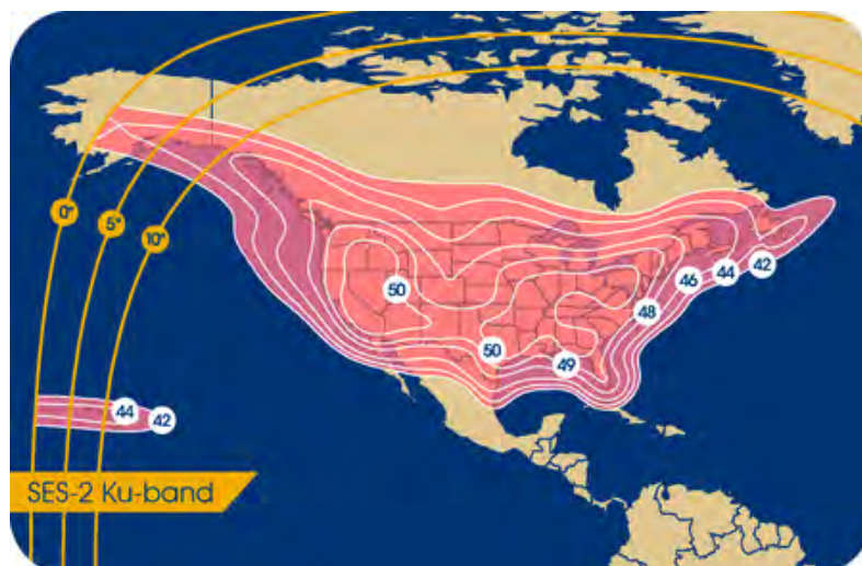
Рис. 76. ЭИИМ (дБ Вт) в рабочих зонах ИСЗ SES-2 (87° з.д.) в Ку-диапазоне частот
