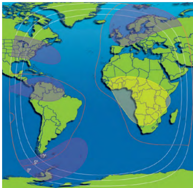
Рис. 129. Рабочие зоны ИСЗ INTELSAT-37e (18° з.д.) в С-диапазоне частот
