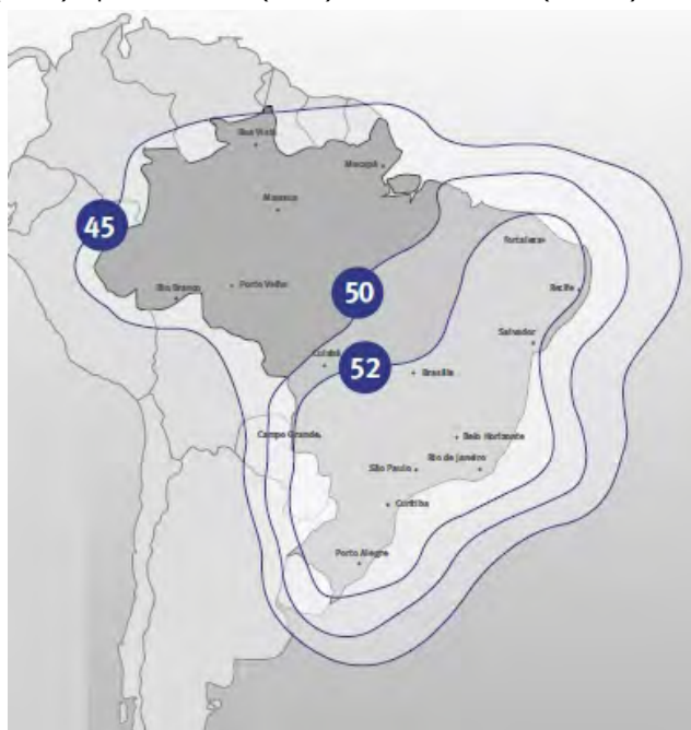
Рис. 18. ЭИИМ (дБ·Вт) в рабочих зонах (Бразилия) ИСЗ STAR ONE-S3 (75° з.д.) в Ku-диапазоне частот
