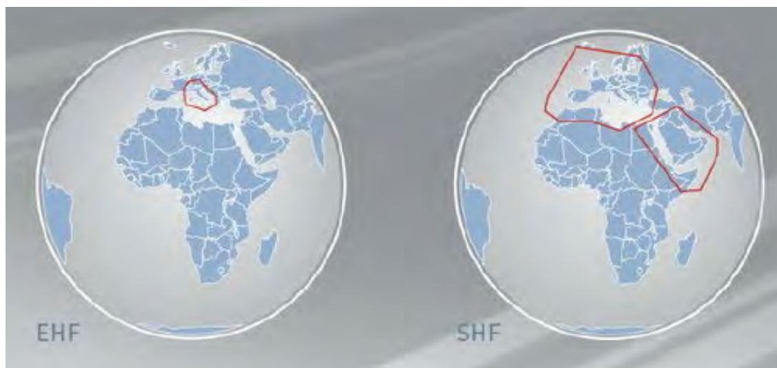
Рис. 2. Рабочие зоны ИСЗ SICRAL-1В (11,8° в.д.) в X- и Ка-диапазонах частот
