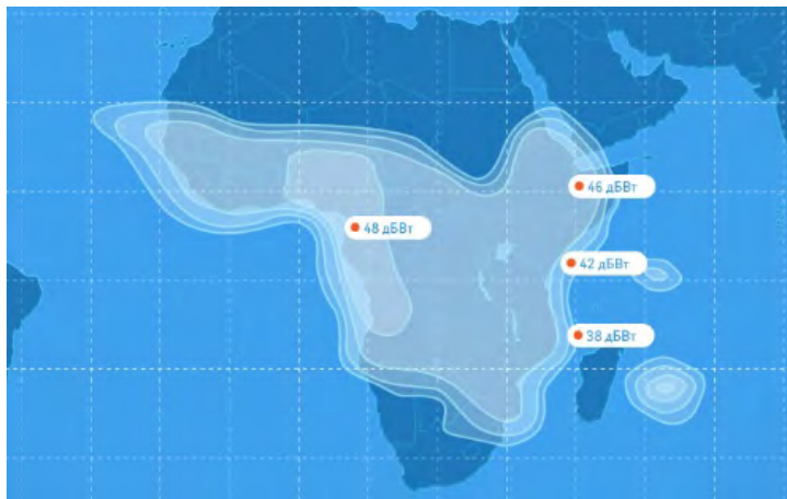
Рис. 53. ЭИИМ (дБ-Вт) в рабочей зоне (2-й фиксированный луч) ИСЗ ЭКСПРЕСС- АМУ-1 (36° в.д.) в Ku-диапазоне частот
