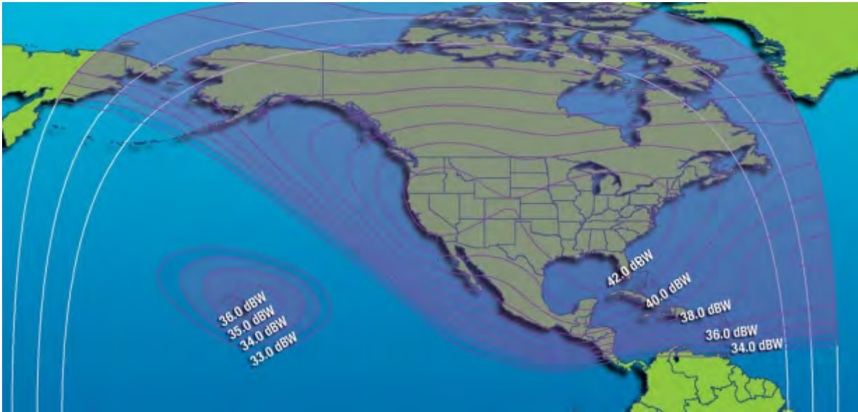
Рис. 58. ЭИИМ (дБ·Вт) в рабочих зонах ИСЗ GALAXY-23 (INTELSAT-A13, 121° з.д.) в С-диапазоне частот
