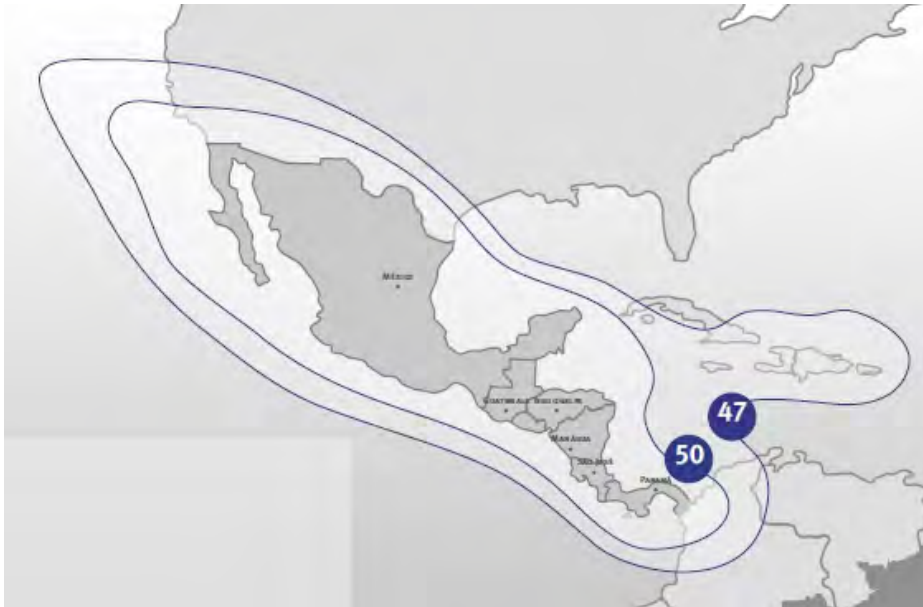
Рис. 26. ЭИИМ (дБ·Вт) в рабочих зонах (Латинская Северная Америка) ИСЗ STAR ONE-D1 (84° з.д.) в Ки-диапазоне частот
