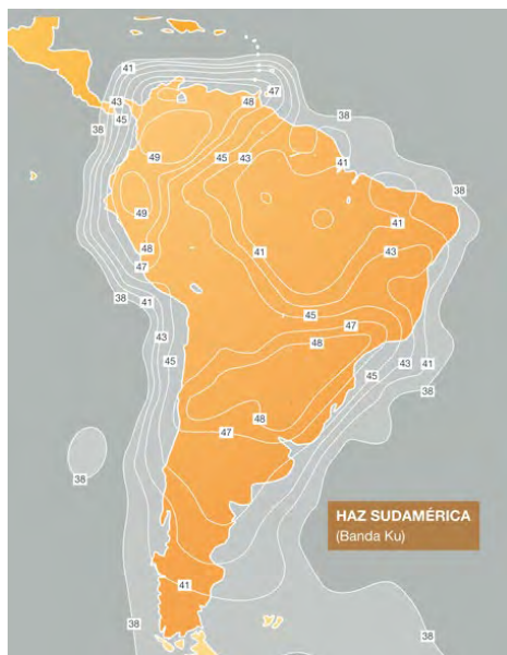
Рис. 30. ЭИИМ (дБ·Вт) в рабочей зоне (на Южную Америку) ИСЗ AMAZONAS-3 (61° з.д.) в Ку-диапазоне частот
