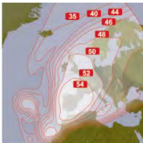
Рис. 3. ЭИИМ (дБ-Вт) в рабочей зоне (на Иберийскую Атлантику и Европу) ИСЗ HISPASAT-30W-4 (-1D) (30° з.д.) в Ки-диапазоне частот
