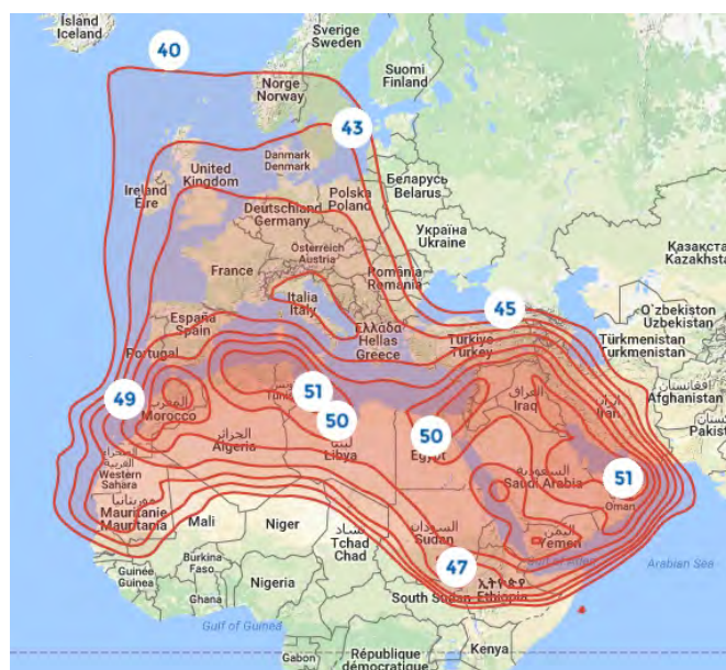
Рис. 5. Рабочие зоны (BSS) IC3 ARABSAT-4B (26° в.д.) в Ку-диапазоне частот
