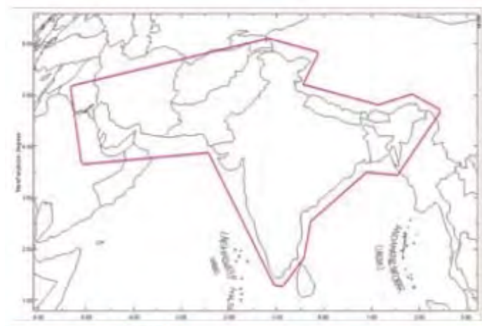
Рис. 3. Рабочая зона ИСЗ GSAT-10 (83° в.д.) в С-диапазоне частот
