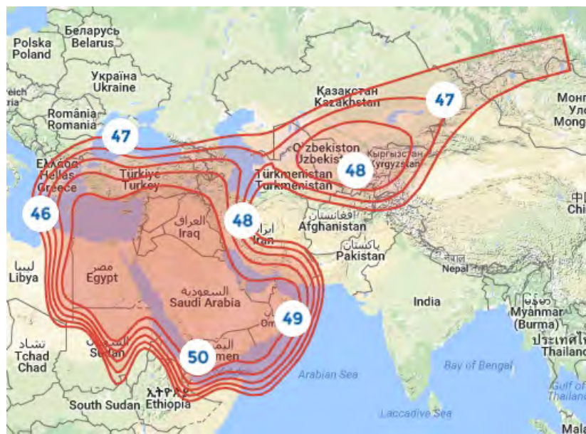
Рис. 29. ЭИИМ (дБ·Вт) в рабочих зонах (East MENA) ИСЗ BADR-7 (26° в.д.) в Ки-диапазоне частот
