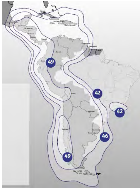
Рис. 21. ЭИИМ (дБ·Вт) в рабочих зонах (Латинская Америка) ИСЗ STAR ONE-C4 (70° з.д.) в Ки-диапазоне частот
