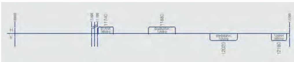
Рис. 11. Частотные планы (а – в С-диапазоне частот, б и в – в Ku-диапазоне частот: б - на Бразилию, в – на восточное побережье Бразилии и Латинскую Северную Америку) ретрансляторов ИСЗ STAR ONE-C2
