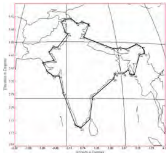
Рис. 6. Рабочая зона ИСЗ GSAT-15 (93,5° в.д.) в Ки-диапазоне частот
