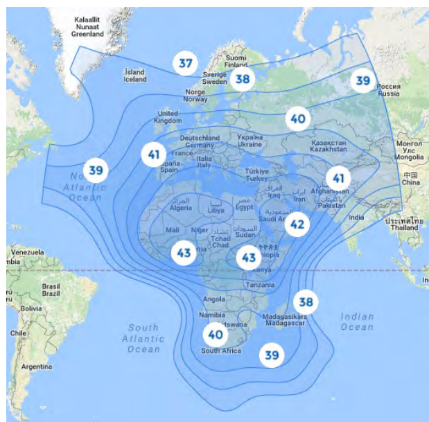
Рис. 25. ЭИИМ (дБ·Вт) в рабочих зонах (ЕМЕА) ИСЗ ARABSAT-5C (20° в.д.) в С-диапазоне частот
