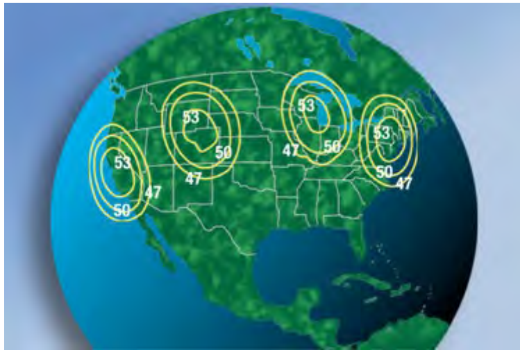
Рис. 69. ЭИИМ (дБ-Вт) в рабочих зонах ИСЗ GALAXY-28 (INTELSAT-A8, 89° з.д.) в Ka-диапазоне частот
