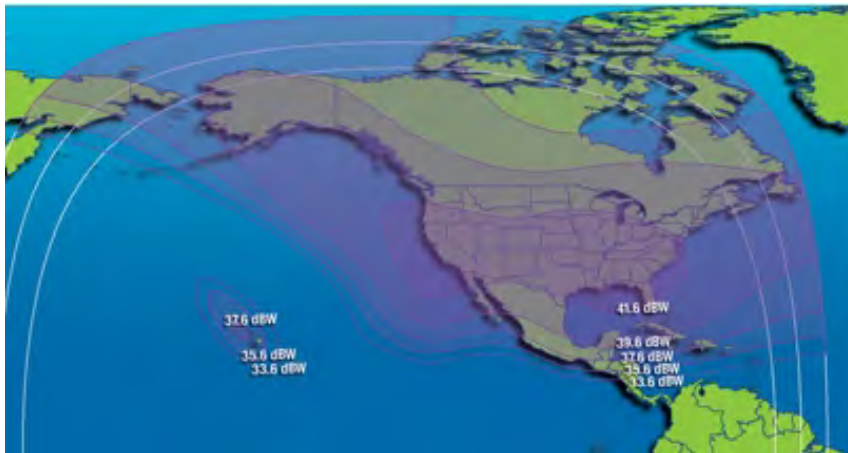
Рис. 56. ЭИИМ (дБ·Вт) в рабочих зонах (горизонтальная поляризация) ИСЗ GALAXY-12 (129° з.д.) в С-диапазоне частот
