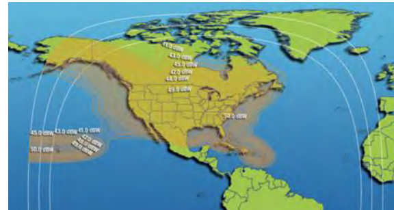
Рис. 67. ЭИИМ (дБ·Вт) в североамериканской рабочей зоне ИСЗ GALAXY-28 (INTELSAT-A8, 89° з.д.) в Ku-диапазоне частот
