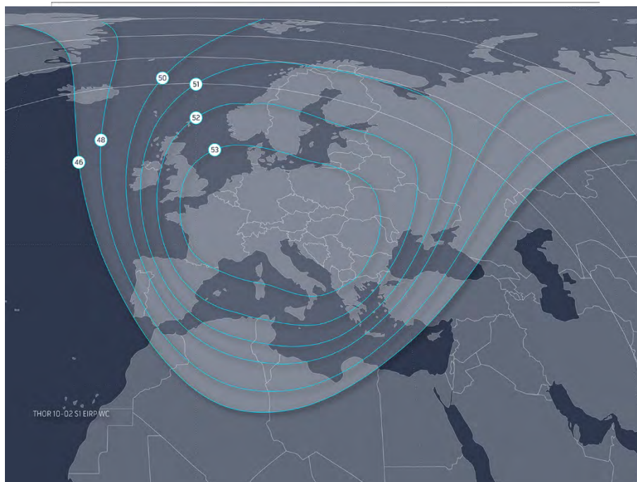
Рис. 1. ЭИИМ (дБ·Вт) в рабочих зонах (луч 1, вертикальная поляризация) ИСЗ THOR-10-02 (INTELSAT-10-02) (1° з.д.) в Ки-диапазоне частот
