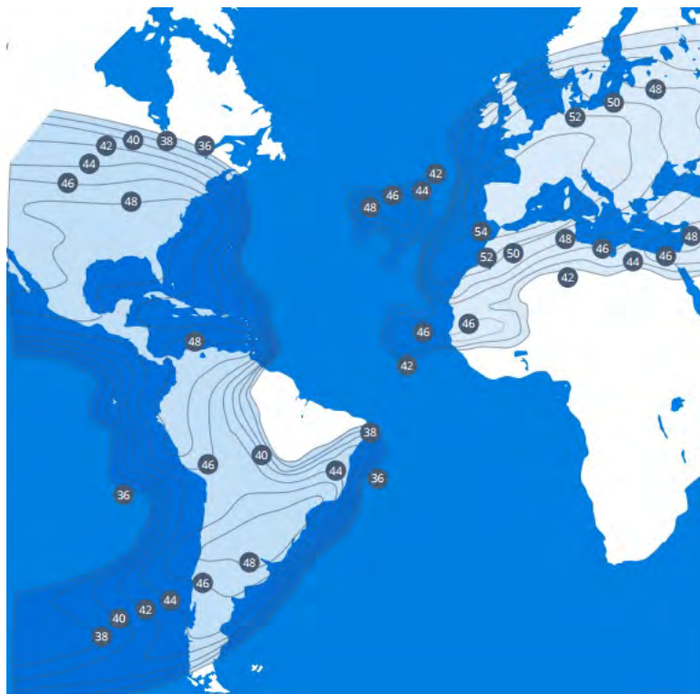
Рис. 5. ЭИИМ (дБ-Вт) в рабочих зонах ИСЗ HISPASAT-30W-5 (-1E) (30° з.д.) в Ки-диапазоне частот
