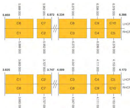
Рис. 11. Частотный план ретрансляторов ИСЗ STELLAT-5 в С-диапазоне частот
