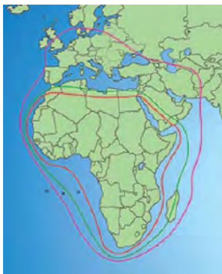
Рис. 18. Планируемая ЭИИМ (дБ·Вт) в рабочих зонах ИСЗ AFRICASAT-2A (5,7° в.д.) в С-диапазоне частот
