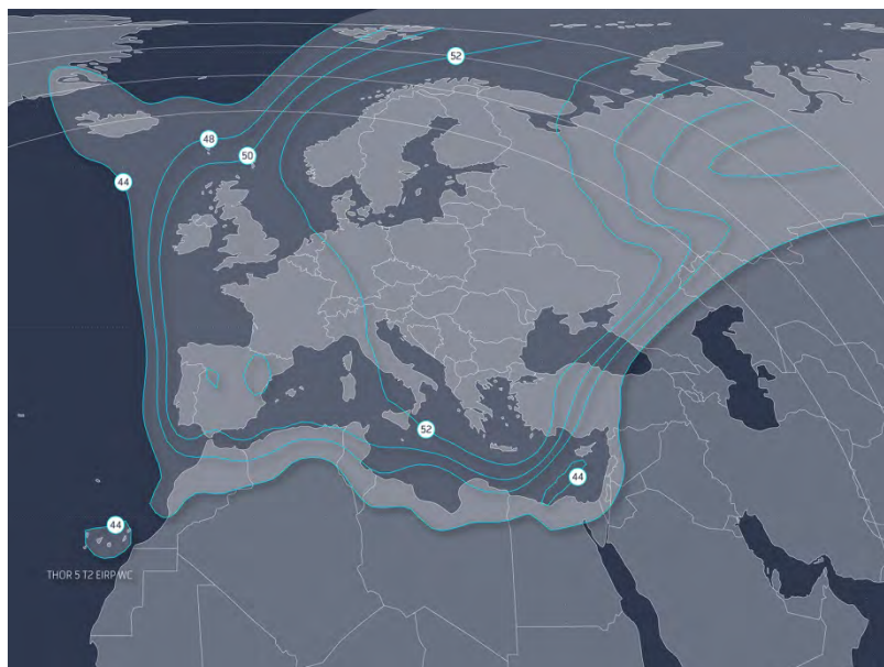
Рис. 4. ЭИИМ (дБ·Вт) в рабочих зонах (Т2) ИСЗ THOR-5 (0,7° з.д.) в Ки-диапазоне частот
