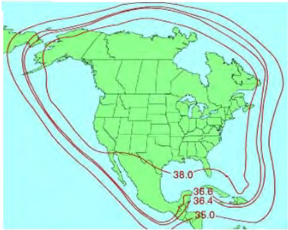
Рис. 10. ЭИИМ (дБ·Вт) в рабочих зонах ИСЗ AMSC и TMI в Ku-диапазоне частот
