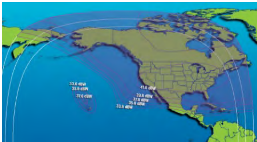
Рис. 73. ЭИИМ (дБ·Вт) в рабочих зонах ИСЗ GALAXY-15 (133° з.д.) в С-диапазоне частот
