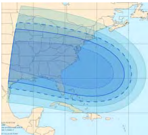
Рис. 17. Рабочие зоны на прием (восточная часть США) ИСЗ серии SKYNET-5 в X-диапазоне частот
