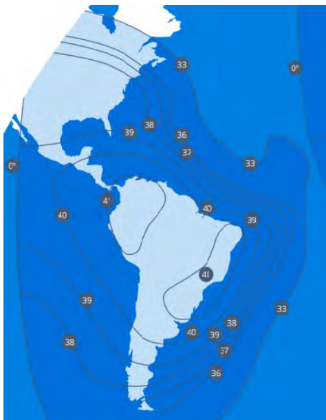
Рис. 19. ЭИИМ (дБ-Вт) в рабочих зонах ИСЗ HISPASAT-30W-6 (-1F) (30° з.д.) в С-диапазоне частот
