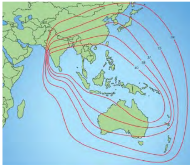
Рис. 16. ЭИИМ (дБ·Вт) в рабочих зонах (а – индийский, б – индонезийский, в – малазийский и г – австралийский лучи) ИСЗ MEASAT-3B (91,5° в.д.) в Ku- диапазоне частот
