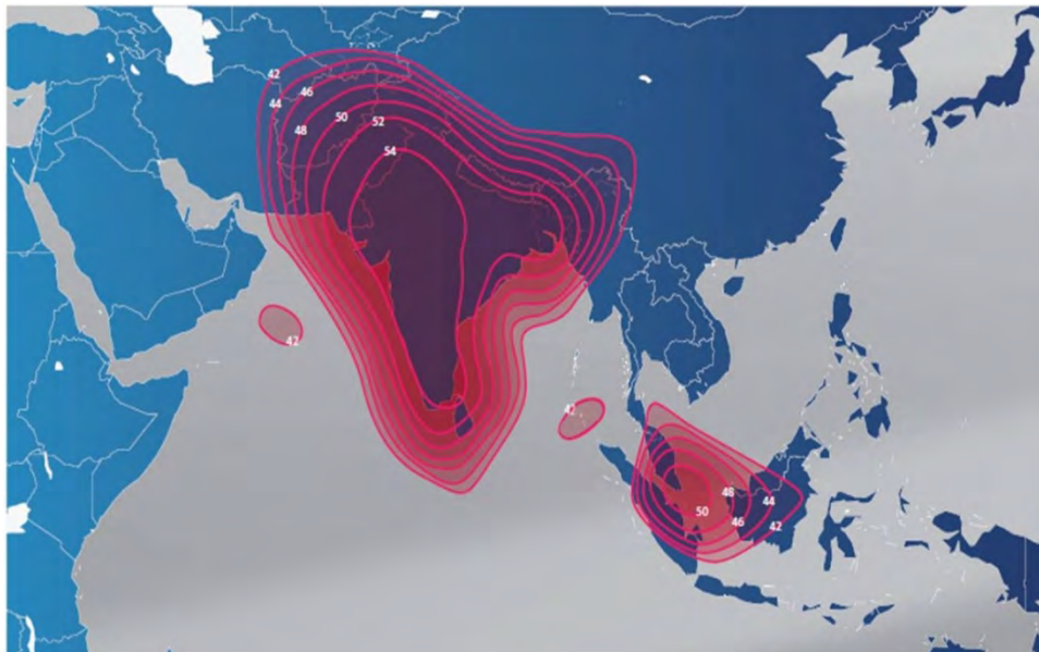
Рис. 43. ЭИИМ (дБ·Вт) в рабочих зонах (Индия и часть Индонезии) ИСЗ ST-2 (88° в.д.) в Ku-диапазоне частот
