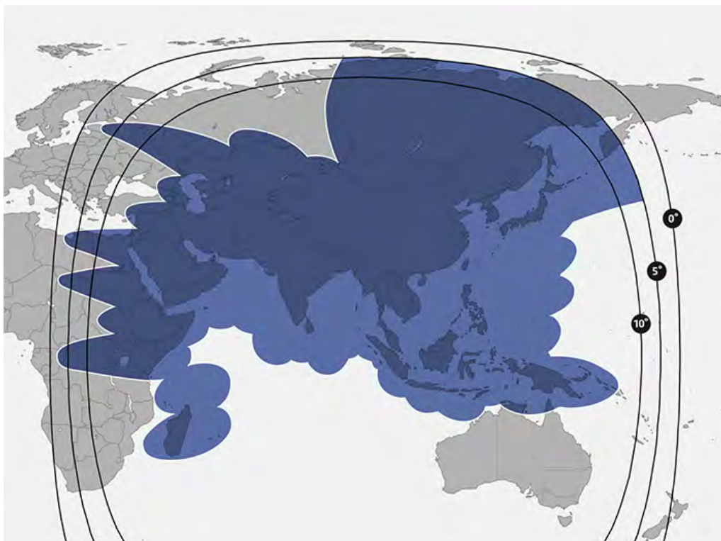
Рис. 141. ЭИИМ (дБ Вт) в рабочих зонах (многолучевая антенна) ИСЗ SES-12 (95° в.д.) в Ки-диапазоне частот
