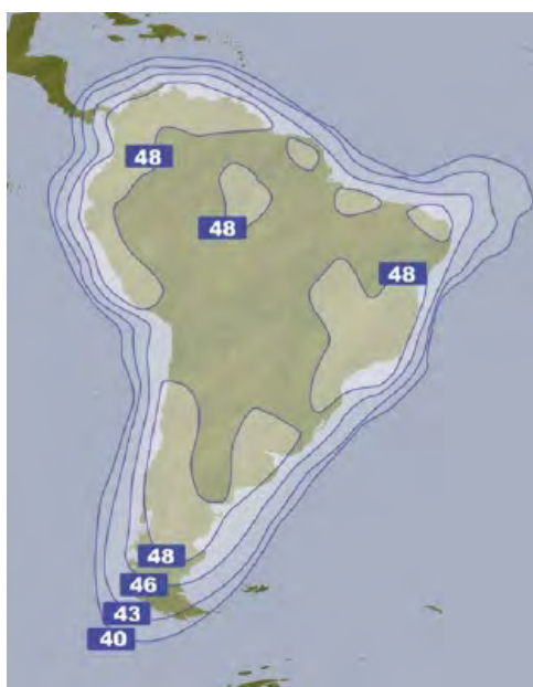
Рис. 27. ЭИИМ (дБ-Вт) в рабочей зоне (на Южную Америку) ИСЗ AMAZONAS-2 (61° з.д.) в Ки-диапазоне частот
