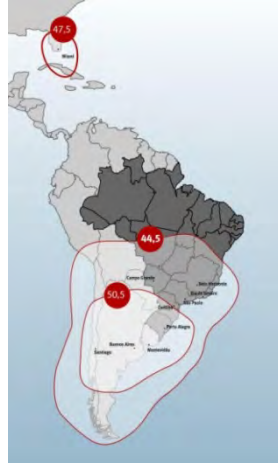
Рис. 10. ЭИИМ (дБ·Вт) в рабочей зоне (на страны Mercosur, Андского региона и штат Флорида, США) ИСЗ STAR ONE-C1 (65° з.д.) в Ku-диапазоне частот
