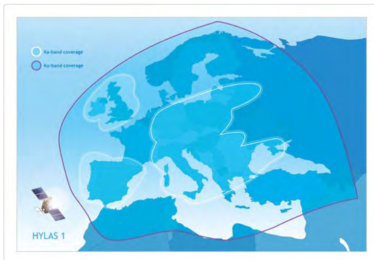
Рис. 34. Рабочие зоны ИСЗ HYLAS-1 (33,5° з.д.) в Ku-/Ka- и Ka-диапазонах частот
