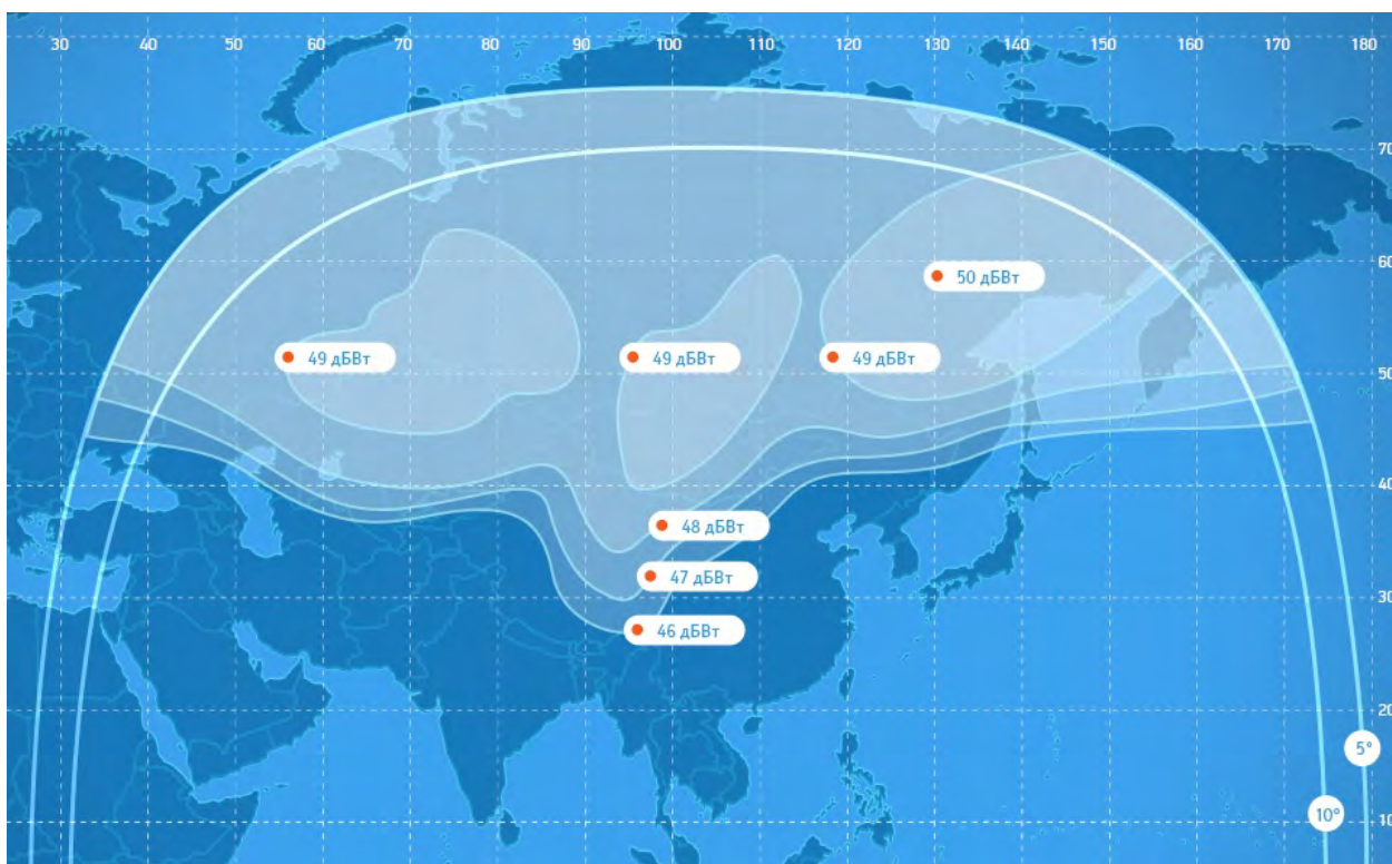
Рис. 4. ЭИИМ (дБВт) в рабочей зоне (фиксированный луч) ИСЗ ЭКСПРЕСС-АМЗ (103° в.д.) в Ки-диапазоне частот
