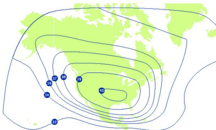
Рис. 51. ЭИИМ (дБ·Вт) в рабочих зонах (а - горизонтальная, б - вертикальная поляризация) ИСЗ GALAXY-3С (95° з.д.) в С-диапазоне частот
