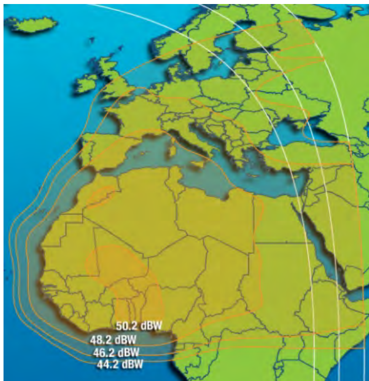
Рис. 126. ЭИИМ (дБ·Вт) в рабочих зонах (Африка и Европа) ИСЗ INTELSAT-35e (34,5° з.д.) в Ки-диапазоне частот
