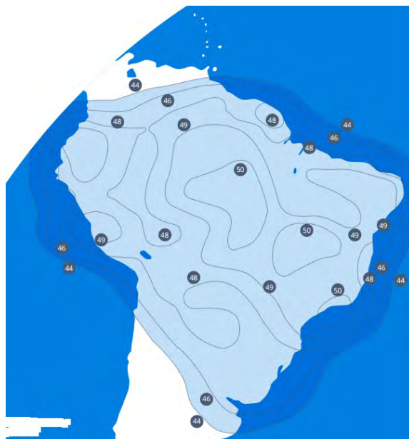
Рис. 14. ЭИИМ (дБ·Вт) в рабочих зонах (на Южную Америку) ИСЗ HISPASAT-36W-1 (36° з.д.) в Ки-диапазоне частот
