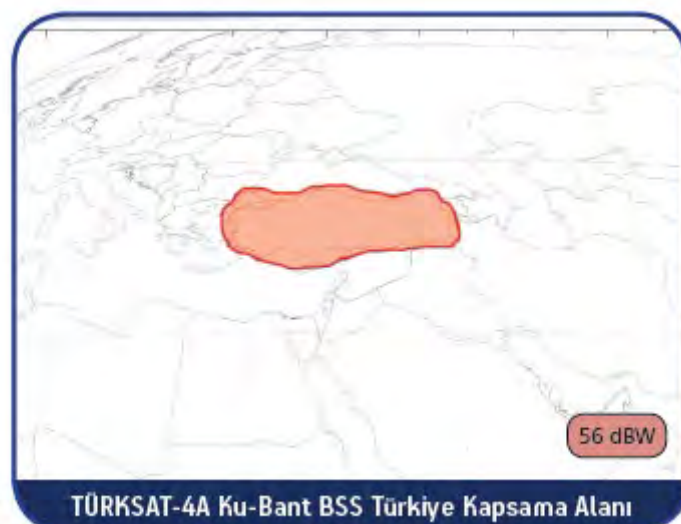
Рис. 23. ЭИИМ (дБ·Вт) в рабочих зонах (Турция, BSS) ИСЗ TURKSAT-4A (42° в.д.) в Ку-диапазоне частот
