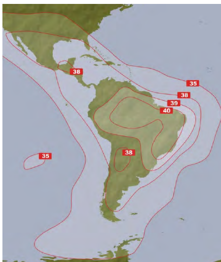
Рис. 25. ЭИИМ (дБ-Вт) в рабочей зоне (на Америку) ИСЗ AMAZONAS-2 (61° з.д.) в С-диапазоне частот
