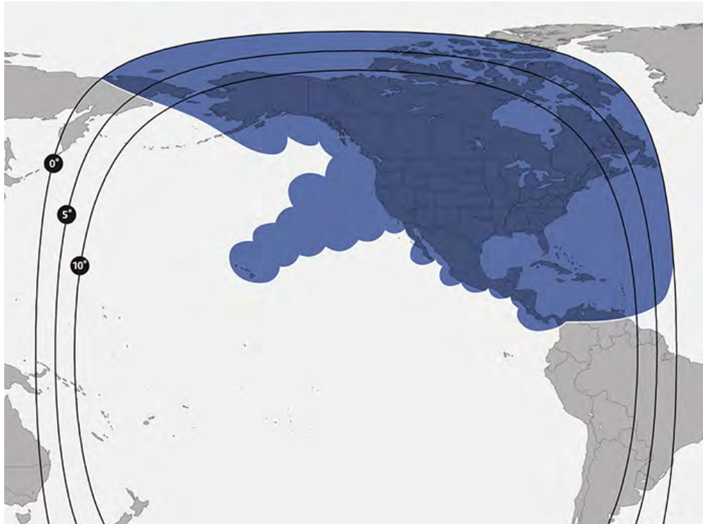
Рис. 123. ЭИИМ (дБ Вт) в рабочих зонах (многолучевая антенна) ИСЗ SES-15 (129° з.д.) в Ku-диапазоне частот
