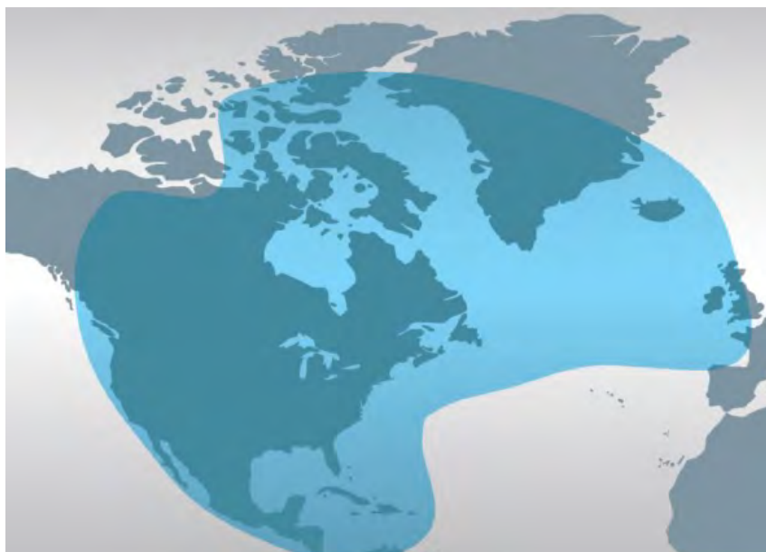
Рис. 89. Рабочие зоны ИСЗ VIASAT-2 (69,9° з.д.) в Ка-диапазоне частот
