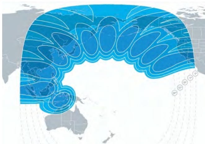
Рис. 81. ЭИИМ (дБ·Вт) в рабочих зонах (многолучевая диаграмма направленности) ИСЗ EUTESAT-172В (172° в.д.) в Ku-диапазоне частот
