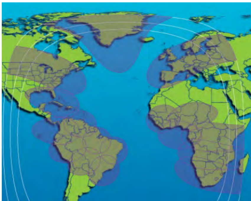
Рис. 125. ЭИИМ (дБ·Вт) в рабочих зонах (узкие лучи) ИСЗ INTELSAT-35e (34,5° з.д.) в С-диапазоне частот
