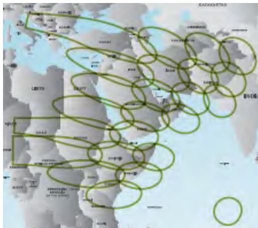
Рис. 16. Планировавшиеся рабочие зоны (24 луча) ИСЗ JABIRU-1 в Ka-диапазоне частот
