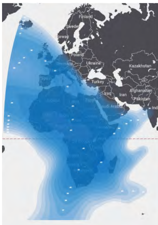
Рис. 1. ЭИИМ (дБ·Вт) в рабочих зонах (Африка и Европа) ИСЗ AFRICASAT-1/AZERSPACE-1 (46° в.д.) в С-диапазоне частот
