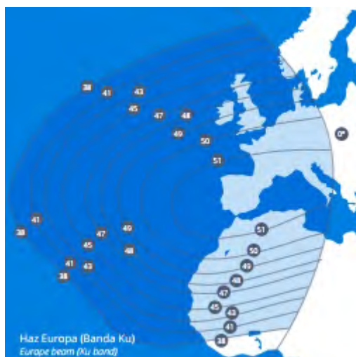
Рис. 32. ЭИИМ (дБ-Вт) в рабочей зоне (Европа) ИСЗ AMAZONAS-3 (61° з.д.) в Ку-диапазоне частот
