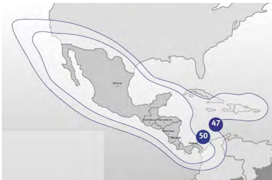
Рис. 18. ЭИИМ (дБ·Вт) в рабочих зонах (Латинская Северная Америка) ИСЗ HISPASAT-84W-2 (STAR ONE-D1) (84° з.д.) в Ku-диапазоне частот
