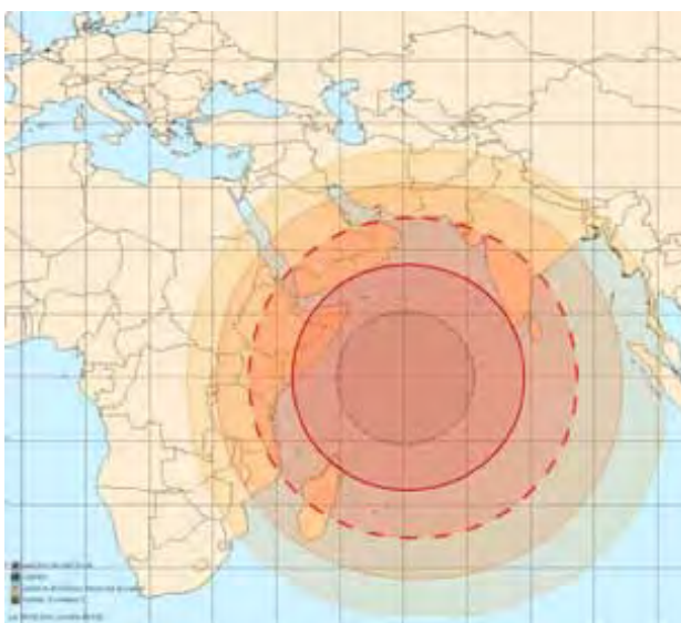
Рис. 23. Рабочие зоны на передачу (Индийский океан) ИСЗ серии SKYNET-5 в X-диапазоне частот
