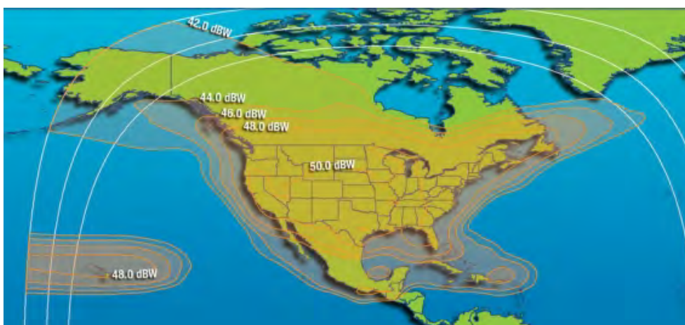
Рис. 2. Частотный план ретрансляторов ИСЗ GALAXY-25 (INTELSAT-A5) (а), ЭИИМ (дБ·Вт) в рабочих зонах ИСЗ GALAXY-25 (INTELSAT-A5, 93° з.д.) в С- (б и в) и Ku- (г) диапазонах частот
