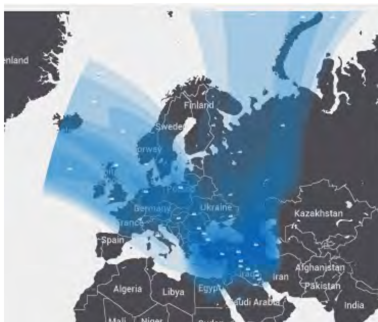
Рис. 4. ЭИИМ (дБ·Вт) в рабочих зонах (Европа) ИСЗ AFRICASAT-1/AZERSPACE-1 (46° в.д.) в Ки-диапазоне частот
