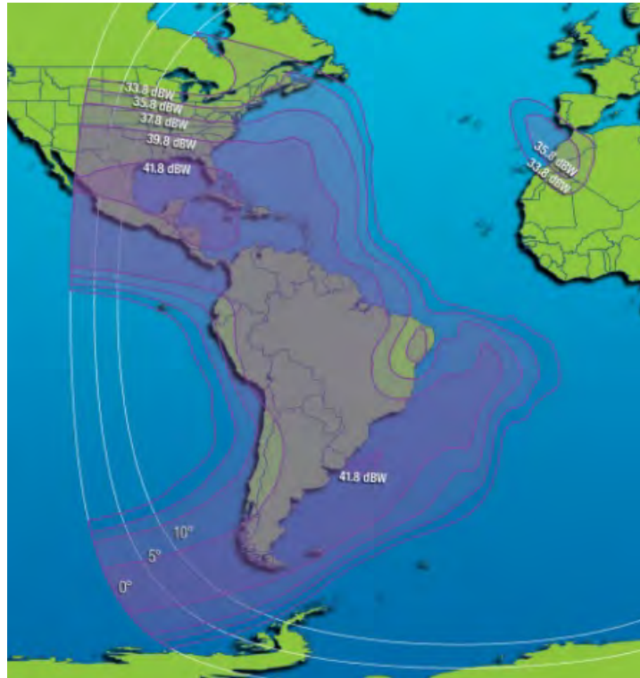
Рис. 11. ЭИИМ (дБВт) в рабочих зонах ИСЗ INTELSAT-9 (PAS-9, 29,5° з.д.) в С-диапазоне частот
