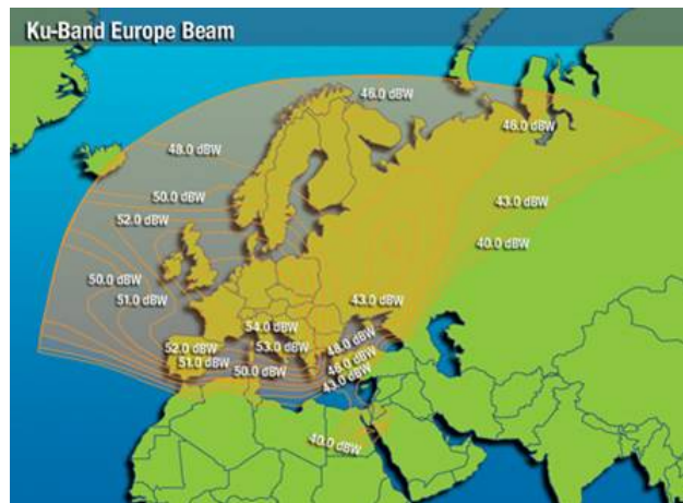
Рис. 16. ЭИИМ (дБ·Вт) в рабочей зоне на Европу ИСЗ INTELSAT-12 (PAS-12, 45° в.д.) в Ку-диапазоне частот
