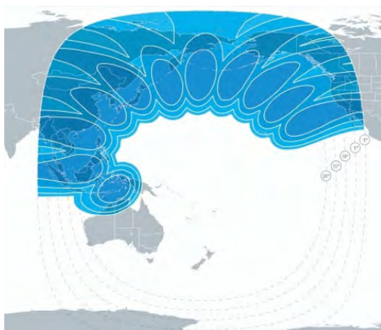
Рис. 23. ЭИИМ (дБ·Вт) в рабочих зонах (многолучевая диаграмма направленности на северо-восточную Азию и север Тихого океана) ИСЗ GE-23 (172° в.д.) в Ки-диапазоне частот
