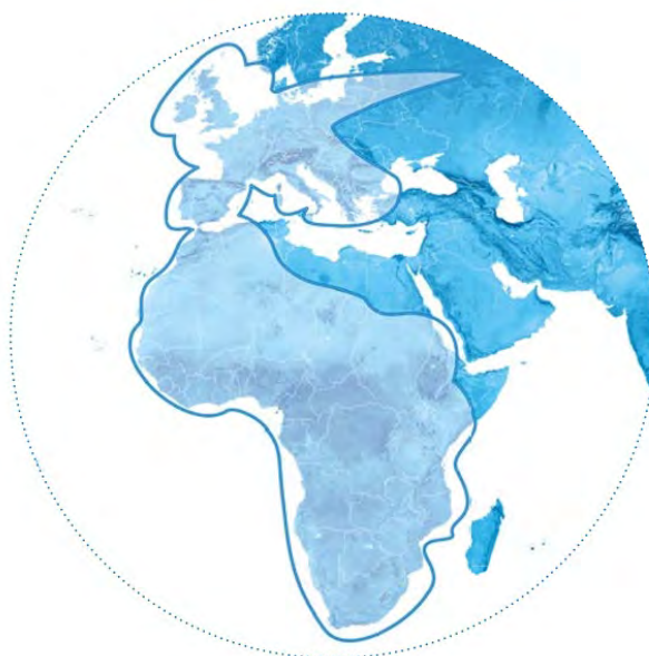
Рис. 37. Рабочие зоны ИСЗ HYLAS-4 (33,5° з.д.) в Ка-диапазоне частот
