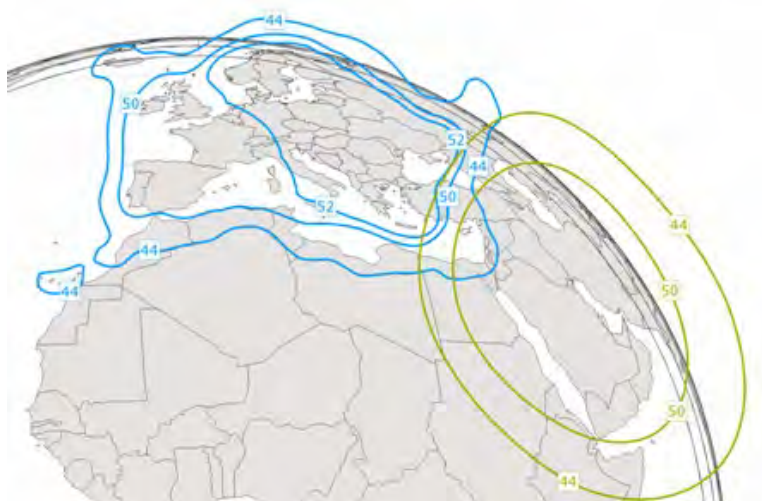
Рис. 5. ЭИИМ (дБ·Вт) в рабочих зонах (перенацеливаемый луч) ИСЗ THOR-5 (0,7° з.д.) в Ки-диапазоне частот
