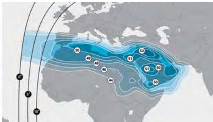
Рис. 110. ЭИИМ (дБ Вт) в рабочих зонах (Ближний Восток и Северная Африка) ИСЗ MONACOSAT (52° в.д.) в Ku-диапазоне частот
