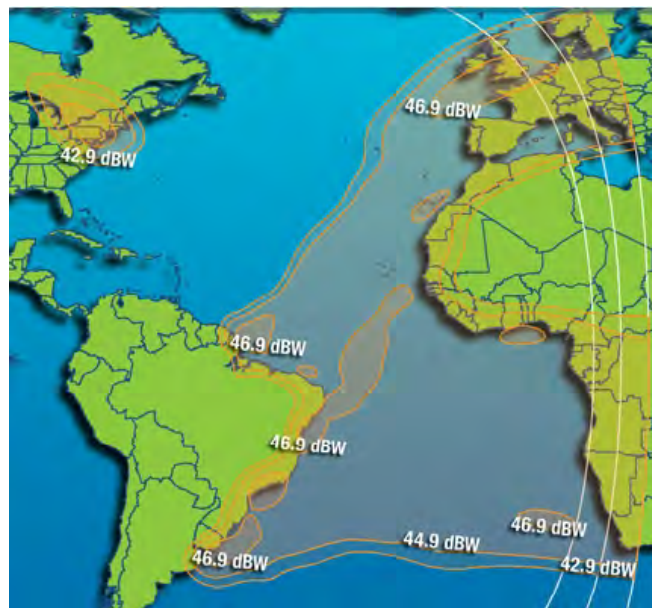
Рис. 108. ЭИИМ (дБ·Вт) в рабочих зонах (подвижные абоненты) ИСЗ INTELSAT-21 (58° з.д.) в Ки-диапазоне частот
