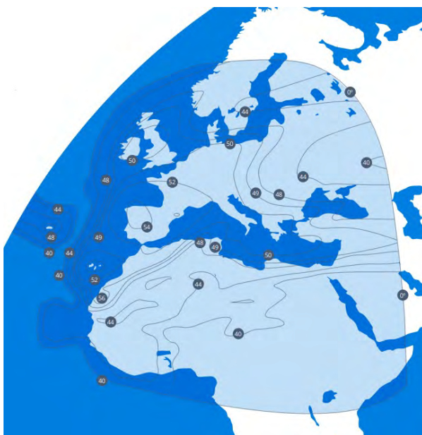
Рис. 19. ЭИИМ (дБ-Вт) в рабочих зонах ИСЗ HISPASAT-30W-6 (-1F) (30° з.д.) в С-диапазоне частот
