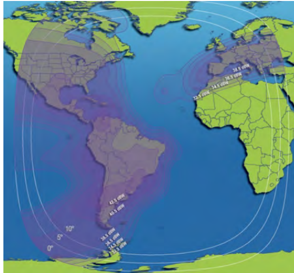
Рис. 77. ЭИИМ (дБ·Вт) в рабочих зонах ИСЗ INTELSAT-11 (43° з.д.) в С-диапазоне частот
