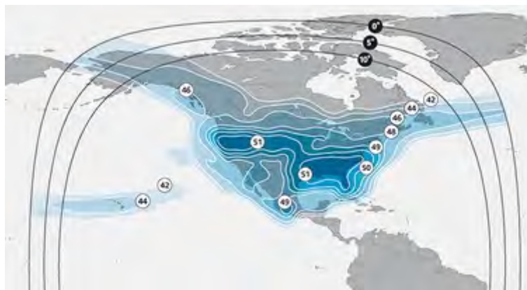
Рис. 28. ЭИИМ (дБ Вт) в рабочих зонах ИСЗ AMC-15 (105° з.д.) в Ku-диапазоне частот
