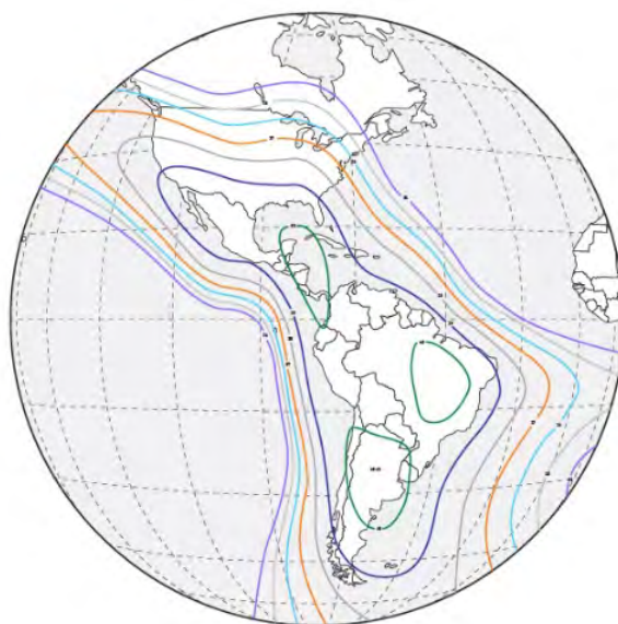
Рис. 94. ЭИИМ (дБ·Вт) в рабочей зоне ИСЗ ARSAT-2 (81° з.д.) в C-диапазоне частот
