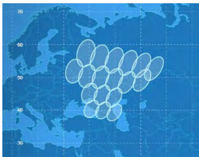
Рис. 54. ЭИИМ (дБ-Вт) в рабочей зоне ИСЗ ЭКСПРЕСС- АМУ-1 (36° в.д.) в Ka-диапазоне частот
