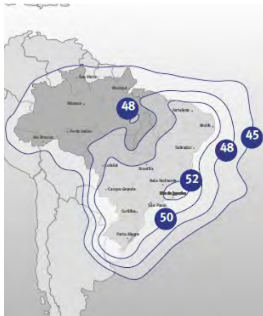
Рис. 20. ЭИИМ (дБ·Вт) в рабочих зонах (Бразилия) ИСЗ STAR ONE-C4 (70° з.д.) в Ки-диапазоне частот
