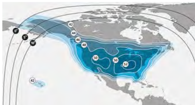
Рис. 71. ЭИИМ (дБ Вт) в рабочих зонах ИСЗ SES-3 ( 103^\circ з.д.) в Ку-диапазоне частот
