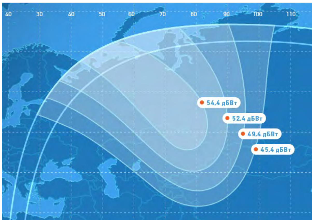
Рис. 10. ЭИИМ (дБВт) в рабочей зоне (1-й вариант перенацеливаемого луча) ИСЗ ЭКСПРЕСС-АМ33 (96,5° в.д.) в Ки-диапазоне частот
