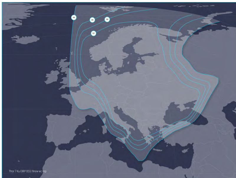
Рис. 8. ЭИИМ (дБ·Вт) в рабочих зонах ИСЗ THOR-7 (1° з.д.) в Ku-диапазоне частот
