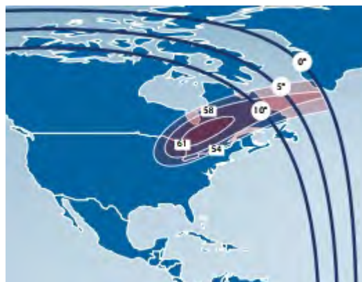
Рис. 41. Рабочие зоны (фиксированная служба) ИСЗ ANIK-F3 (108,75° з.д.) в Ки-диапазоне частот
