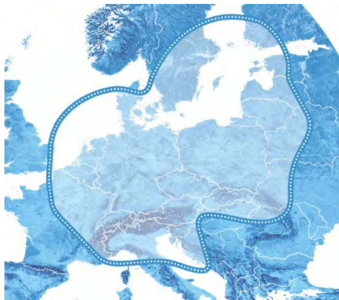
Рис. 36. Рабочие зоны ИСЗ HYLAS-2B (HYLAS-2, 31° в.д.) в Ка-диапазоне частот
