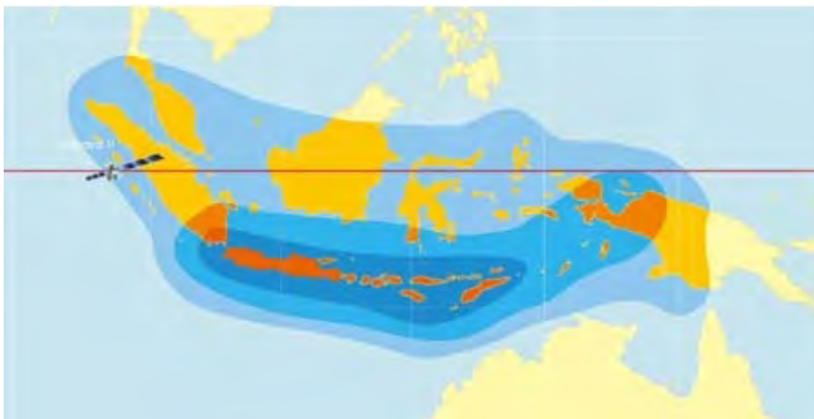
Рис. 19. Планировавшиеся рабочие зоны (Индонезия) ИСЗ CHINASAT-11 (87,5° в.д.) в Ku-диапазоне частот
