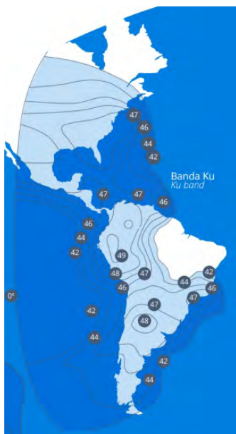
Рис. 20. ЭИИМ (дБ·Вт) в рабочих зонах ИСЗ HISPASAT-30W-6 (-1F) (30° з.д.) в Ку-диапазоне частот
