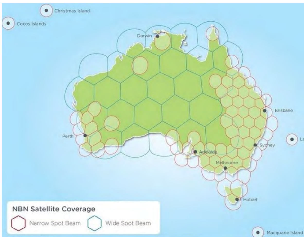
Рис. 1. Рабочие зоны ИСЗ NBN-1A (140° в.д.) в Ка-диапазоне частот
