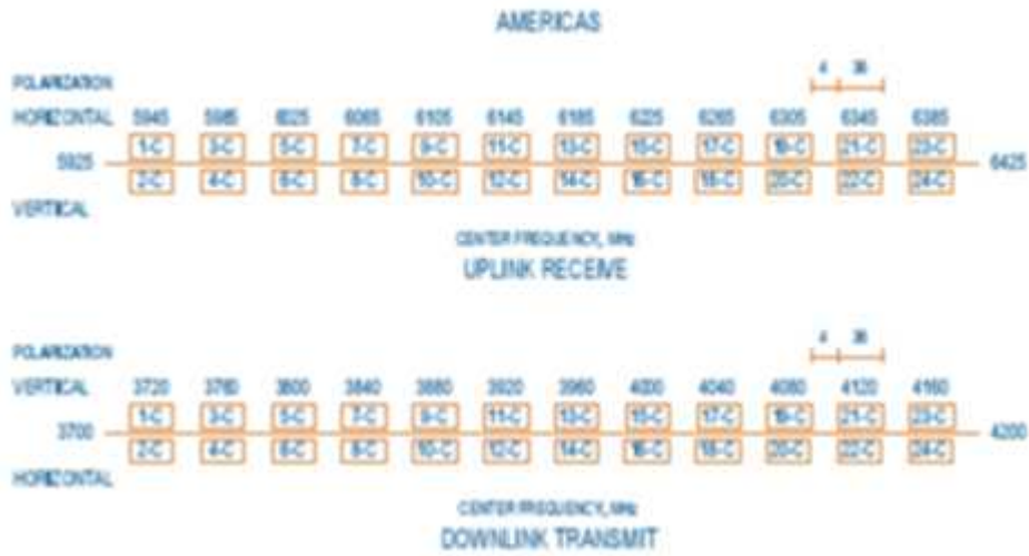
Рис. 8. Частотный план ретрансляторов ИСЗ INTELSAT-9 (PAS-9) в С-диапазоне частот
