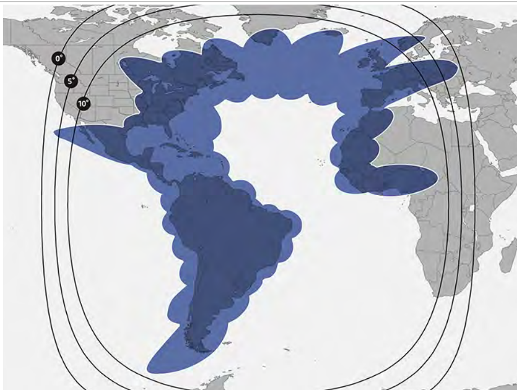
Рис. 133. ЭИИМ (дБ Вт) в рабочих зонах (многолучевая антенна) ИСЗ SES-14 (47,5° з.д.) в Ки-диапазоне частот
