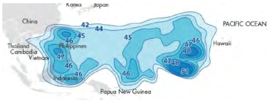
Рис. 55. ЭИИМ (дБ Вт) в рабочих зонах (8 ретрансляторов с полосами частот по 27 МГц, горизонтальная поляризация, южный луч) ИСЗ ABS-6 (ABS-1, LMI-1) (159° в.д.) в Ku-диапазоне частот
