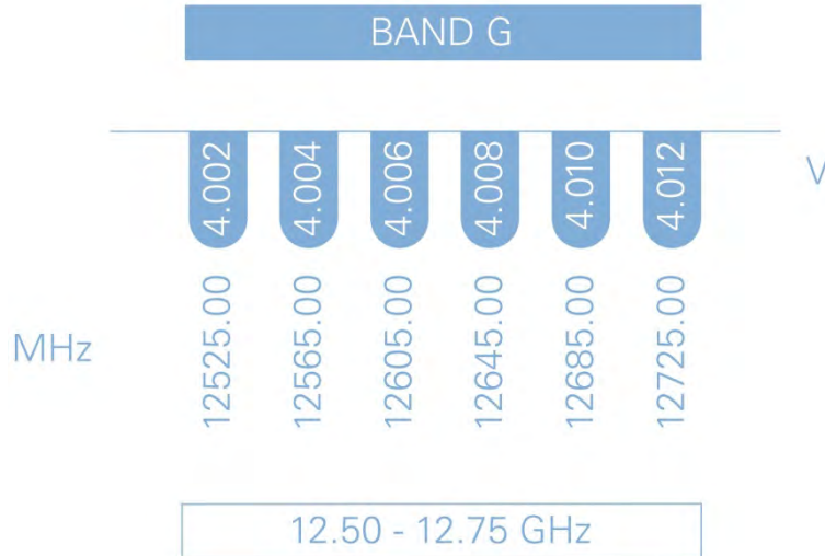
Рис. 40. Частотный план ретрансляторов ИСЗ ASTRA-4A в Ки-диапазоне частот
