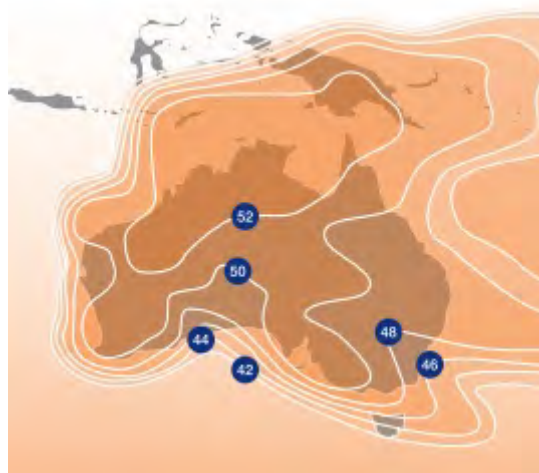
Рис. 16. ЭИИМ (дБ·Вт) в рабочих зонах (а – индийский, б – индонезийский, в – малазийский и г – австралийский лучи) ИСЗ MEASAT-3B (91,5° в.д.) в Ku- диапазоне частот
