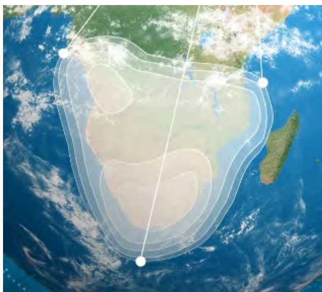
Рис. 34. Рабочие зоны (а – FSS, б – BSS, в – ME, г – SA) ИСЗ HELLAS-SAT-3 (39° в.д.) в Ки-диапазоне частот
