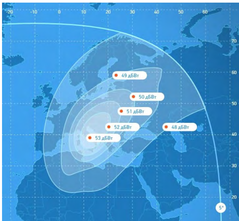
Рис. 13. ЭИИМ (дБ·Вт) в рабочей зоне (1-й вариант перенацеливаемого луча) ИСЗ ЭКСПРЕСС-АМ44 (11° з.д.) в Ки-диапазоне частот
