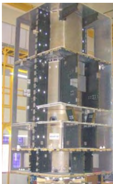
Рис. 4.25. Платформа I-6000 в процессе сборки
